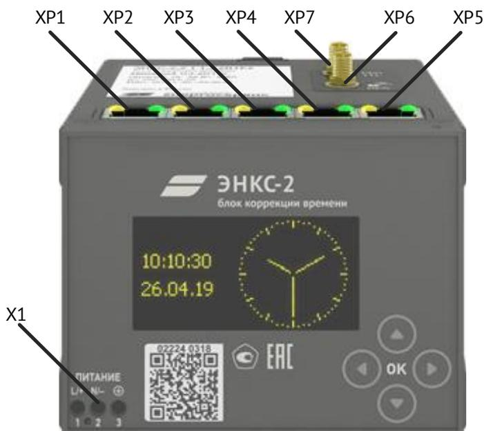
Рисунок 2.1. Разъемы и интерфейсы БКВ ЭНКС-2.
