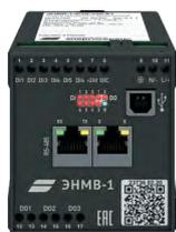
Модули ввода-вывода ЭНМВ-1 с 6 дискретными входами и 3 релейными выходами (250 В~ 8 А, 250В= 0.25 А). Передача данных по RS-485. Поддержка Modbus RTU, МЭК 60870-5-101.
