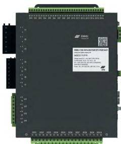
Преобразователи аналоговых и дискретных сигналов ENMU применяются на цифровых подстанциях для аналого-цифрового преобразования сигналов трансформаторов тока и напряжения и сопряжения дискретных сигналов с шиной процесса и шиной подстанции. IEC 61850-9-2 (4 потока), IEC 61850-8-1 (MMS, GOOSE), МЭК 60870-5-104, С37.118.2 (УСВИ/PMU). Регистрация аварийных событий (FTP). Синхронизация времени в соответствии с IEEE 1588v2 PTP.
