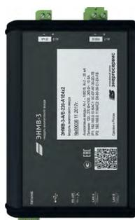
Измерительный преобразователь постоянного тока для измерения параметров цепей возбуждения генераторов для СМГР. Интерфейсы: 1 × RS-485, 2 × 100Base-TX. Поддержка МЭК 60870-5-104, С37.118.2, IEEE 1588v2 PTP.
