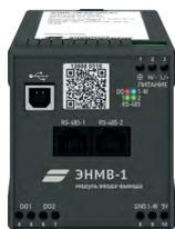
Модуль ввода-вывода с датчиками температуры, влажности и давления, подключаемыми по шине 1-Wire (до 30 датчиков). Дискретные выходы SSR (300 В~/0,12 А, 250 В~/0,12 А). Передача данных по двум RS-485. Поддержка МЭК 60870-5-101, Modbus RTU.
