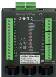
Измерение параметров режима электрической сети, технический учет электроэнергии. Оптимизирован для применения в ячейках КРУ 6-20 кВ. На борту 12 дискретных входов 24 В= и 3 дискретных выхода 250 В~/= 6 А. Питание от двух источников 24 В=. Два независимо настраиваемых интерфейса RS-485. Дополнительные входы контроля напряжения. Для отображения измеряемых параметров используется модуль индикации ЭНМИ.
