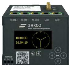
Блок коррекции времени ЭНКС-2 предназначен для синхронизации времени серверов, рабочих станций и устройств (NMEA 0183, SNTP, PTPv2, IRIG, PPS). Синхронизируется от навигационных спутниковых систем ГЛОНАСС, GPS. Имеет несколько интерфейсов: 2 × RS-485, 1 × RS-232, 2 × 100Base-TX.
