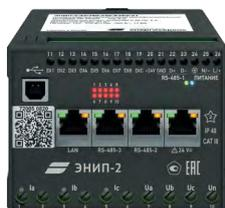
Измерение параметров режима электрической сети, технический учет электроэнергии. Встроенные дискретные входы (DI), дискретные выходы (DO). Подключение до 10 внешних модулей для расширения количества обрабатываемых дискретных сигналов. МЭК 61850-8-1 (MMS, GOOSE) сертифицирован в DNV GL (КЕМА). Для отображения измеряемых параметров используется модуль индикации ЭНМИ.
