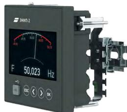
Измерение параметров режима электрической сети, технический учет электроэнергии, отображение информации на цветном сенсорном дисплее. Подключение до 10 внешних модулей для обработки дискретных сигналов. Универсальные измерительные входы, к которым можно подключать токовые цепи с номинальными значениями 1 и 5 А, цепи напряжения с номинальными значениями 57,7, 230 и 400 В (фазные).
