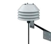
HPTS-1W-5 – датчик температуры (-40...+70 °С), влажности (0...100%), давления (60...115 кПа), длина 5 м
